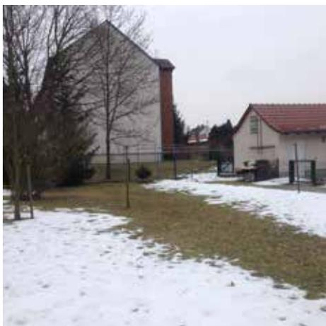
Abb.2 Wärmeversorgung von der Kita zum Mehrfamilien-Wohnblock – sichtbar durch Fehlen von Schnee
