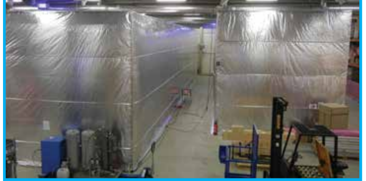
Abb. 3 Zwei große flexible Folienzelte mit Stickstoffgenerator im Einsatz gegen Splintholzkäfer in Frankfurt
