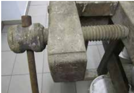
Abbildung 1: Diese rund 80 Jahre alte Werkbank aus Holz wies einen aktiven Befall mit dem Gewöhnlichen Nagekäfer auf.
