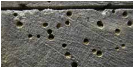
Abbildung 2: Fluglöcher des Gewöhnlichen Nagekäfers in einer rund 80 Jahre alten Werkbank aus Holz.
