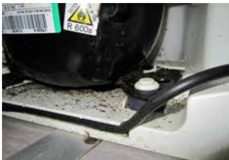
Abbildung 10: Der Bereich des Kühlschrankmotors war massiv mit Schabekot verschmutzt
