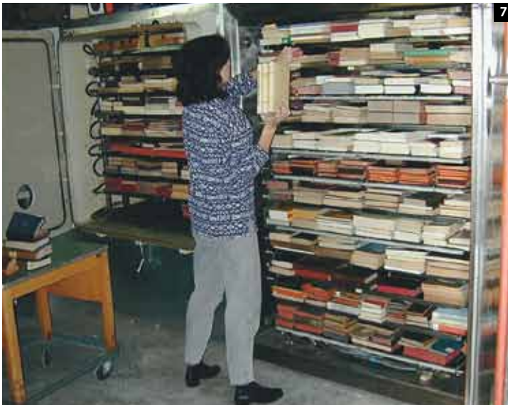
Abb. 7: Auch eine Schutzmaßnahme gegen mikrobiellen Kontakt – Spezialtrockenschränke für feuchte und mikrobiell belastete Bücher und Papierwaren
