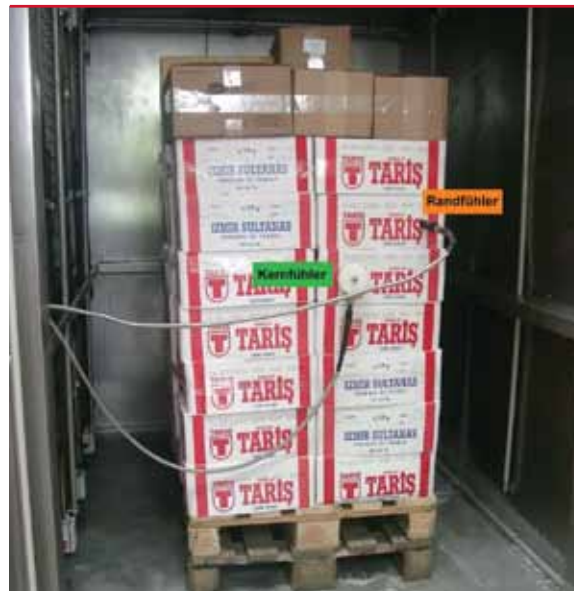
Abb.2 Kaltentwesung (mit Messfühlern) zur Temperaturkontrolle
